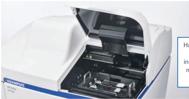
Paso 1. Abrir la tapa y colocar las muestras. El sistema admite placas, portaobjetos, placas de pocillos, matraces y mucho más.
